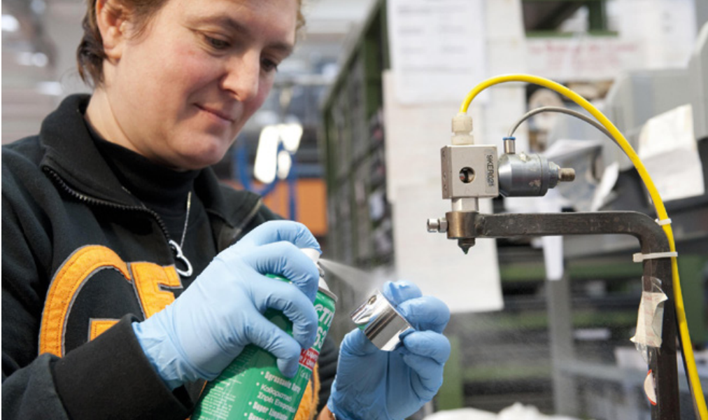
Oberflächen von nichtrostendem Stahl müssen vor dem Kleben sorgfältig vorbehandelt werden. Foto: Loctite, Düsseldorf (D)
